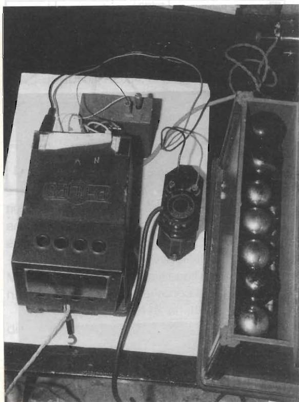
figura 4 - Complessivo per il funzionamento dell'apparecchio radio posto sulla destra. A sinistra l'alimentatore anodico, in alto le batterie per i filamenti, al centro il carica batterie.
